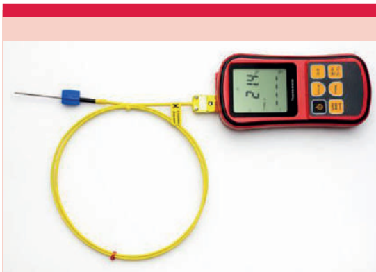
Figura 5. Pirómetro con cable y aguja termopar.
