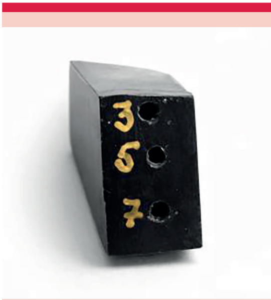
Figura 4. Plantilla o guía para determinar la profundidad de la congelación.
