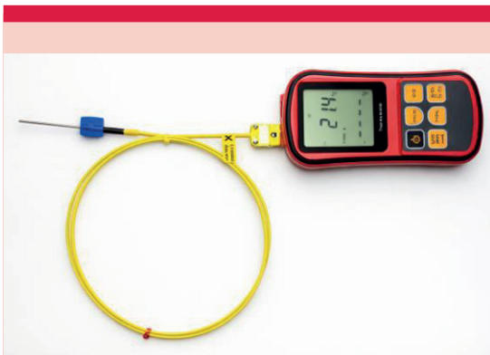
Figura 5. Pirómetro con cable y aguja termopar.
