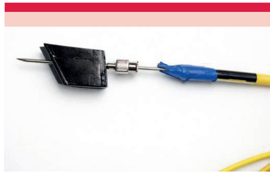
Figura 6. Aguja termopar, dentro de una aguja 16 y ésta, a su vez, dentro de la plantilla.
